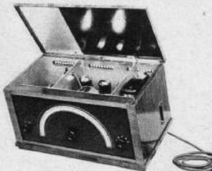
Schon früher wurde der Netzteil (rechts) abgeschirmt und ängstlich vom übrigen Teil des Apparates getrennt
