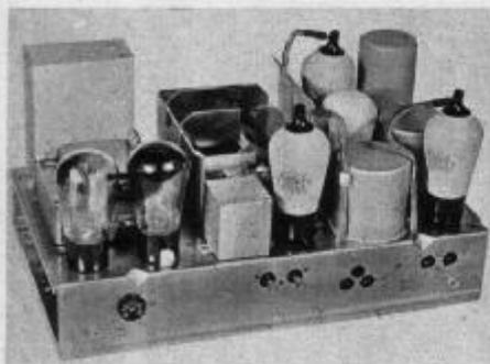
Im Bild rechts der voll geschirmte Netzteil für Wechselstrom bei einem modernen Empfänger
