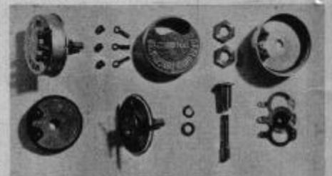
Abb. 69 Einzelteile eines veränderlichen (variablen) Hochohmwiderstandes oder Hochohmpotentiometers. Hat das Ding zwei Anschlußschrauben, ist es ein Hochohmwiderstand, bei drei Anschlußschrauben ein Hochohmpotentiometer
