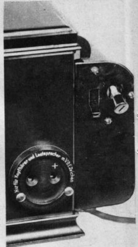
Abb. 80 Hier sitzt die Netzsicherung
