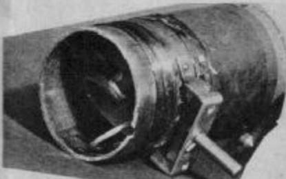
Abb. 31 Älterer Hochfrequenzübertrager aus einem guten Industriempfänger von 1927
