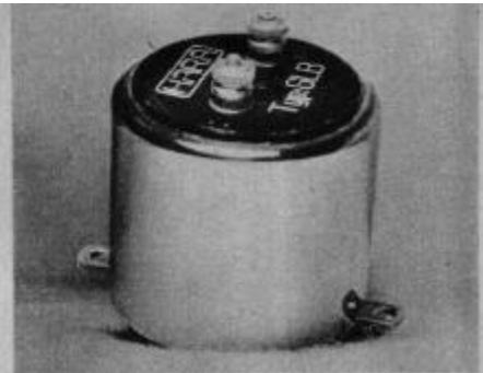
Abb. 26a Luftblock von 250 cm zur Verkürzung der Antenne
