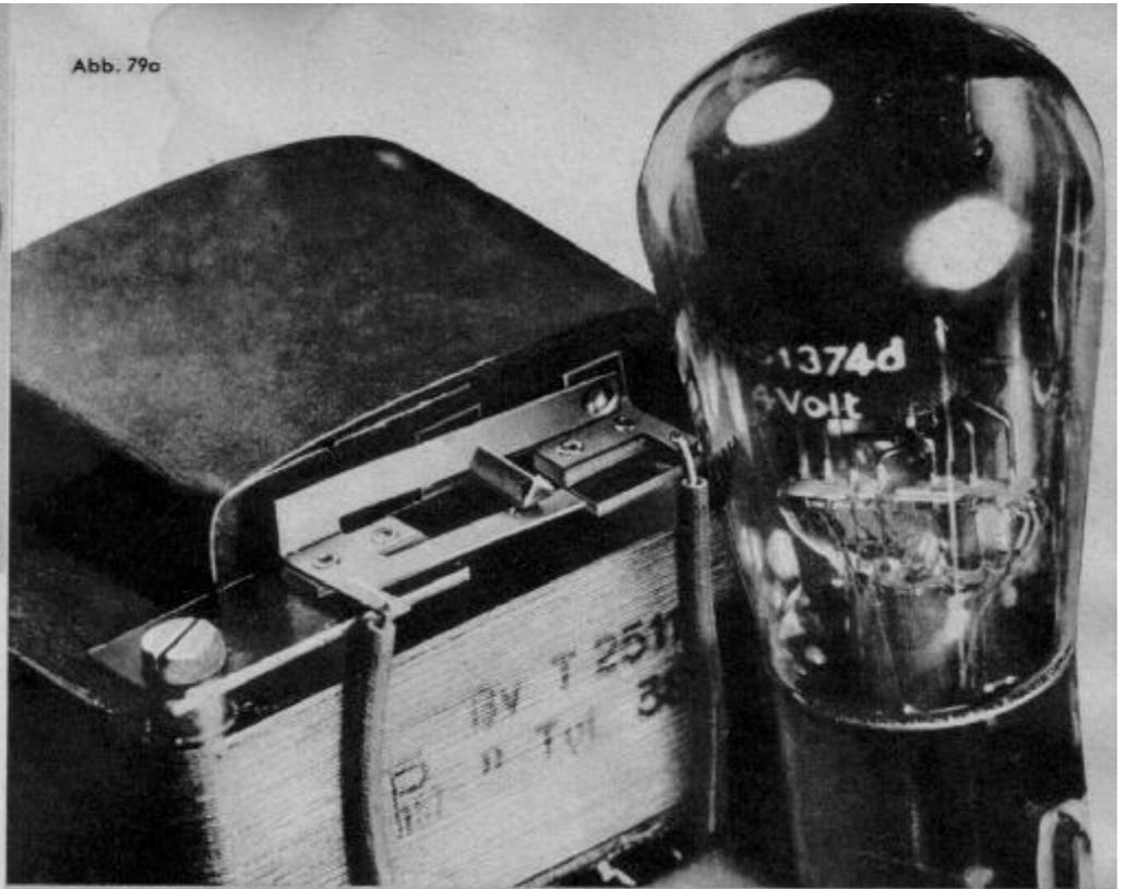
Abb. 78 Umschaltvorrichtung für einen Netztransformator
