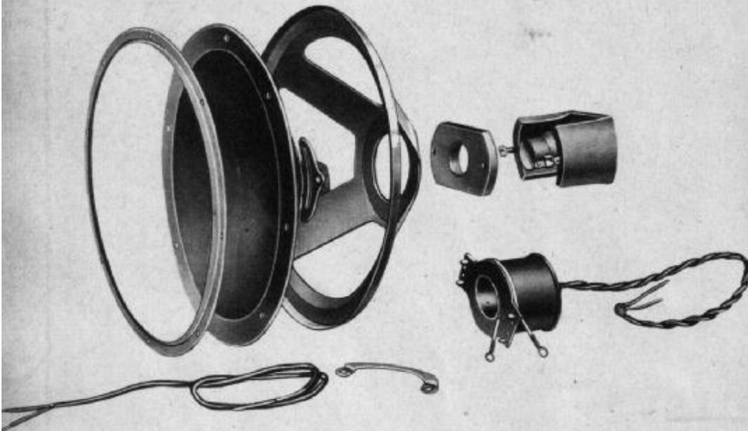
Abb. 262 Der „Elektrodynamische“ von P. Graßmann zerlegt
