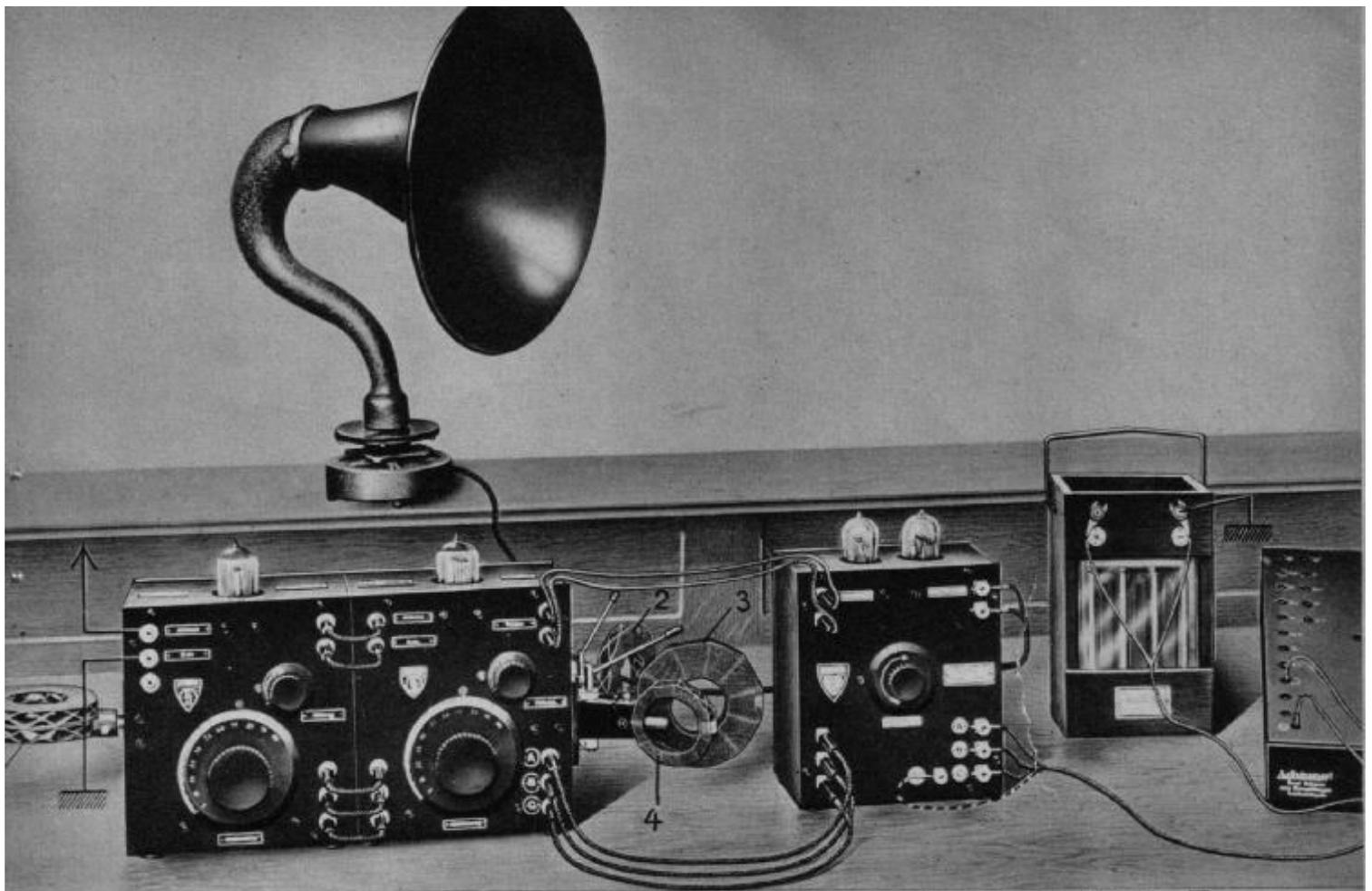
Abb. 129 Hier haben wir wirklich noch die einzelnen „Stufen“ eines Empfängers vor uns: Links die „Hochfrequenzstufe“, daneben die „Audionstufe“ — dann die beiden „Niederfrequenzstufen“ in einem Kästchen vereinigt — und ganz rechts die Stromquellen, welche jetzt meist durch die „Lichtnetzstufe“ oder „Netzanschlußstufe“ ersetzt sind. Von diesen „Stufen“ kennen wir erst den „Netzanschluß“. Nun folgen die übrigen.
