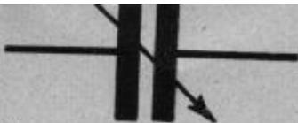
Abb. 1 Schaltsymbol des Drehkondensators
