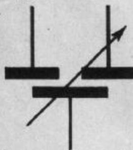
Abb. 15 Schaltbild des Differential-Drehkondensators
