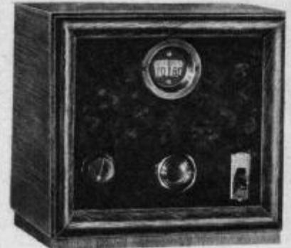
Abb. 135 Lenzola-Wellenventil, eines der besten Vorsatzgeräte zur Trennschärfteerhöhung älterer Empfänger
