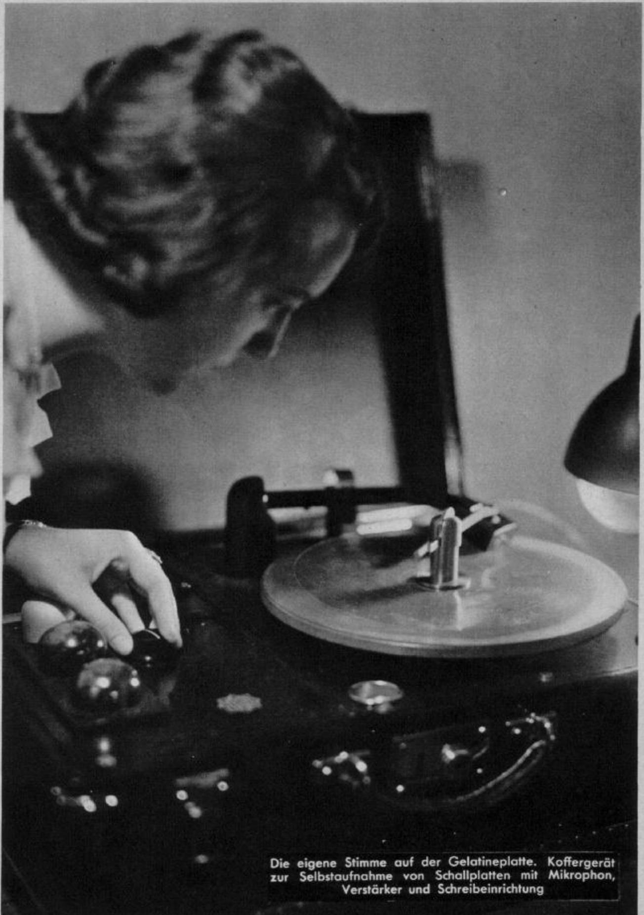
Die eigene Stimme auf der Gelatineplatte. Koffergerät zur Selbstaufnahme von Schallplatten mit Mikrophon, Verstärker und Schreibeinrichtung
