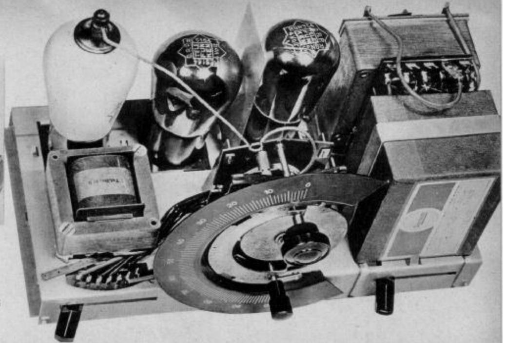
Abb. 182 Moderner Einkreis mit zwei Schirmgitterröhren
