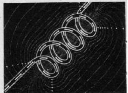
Abb. 128 Warum muß der Netzanschlußteil gut abgeschirmt sein? Weil, wie das Bild zeigt, der Lichtnetzstrom im Netzanschlußteil Magnetfelder erzeugt, welche die Hochfrequenzteile des Empfängers empfindlich stören könnten, so daß wüstes Brummen aus dem Lautsprecher käme: Brummen läßt meist auf Fehler im Netzteil des Gerätes schließen
