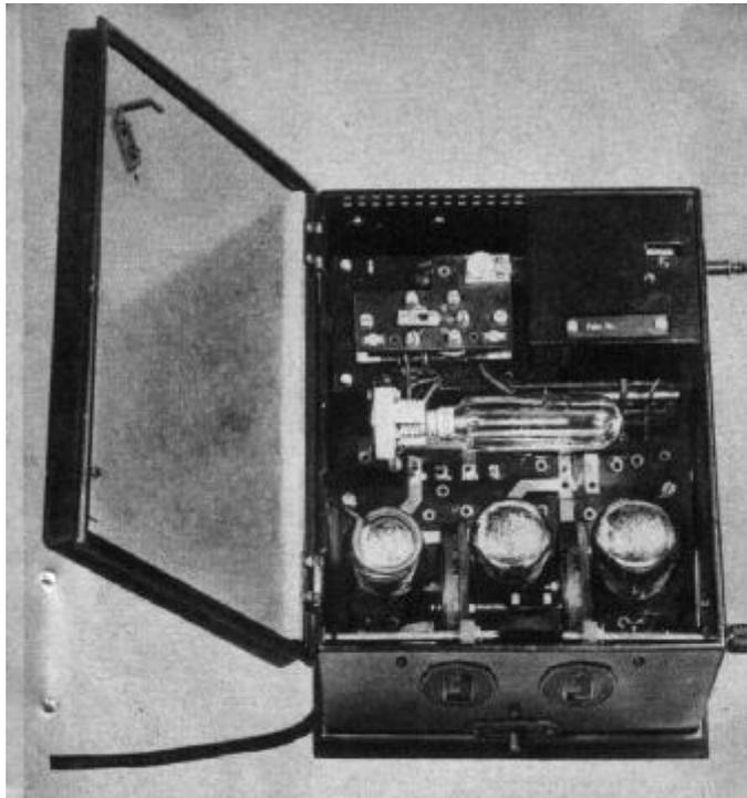
Abb. 70 In der Bildmitte ist ein „Lampenwiderstand“ zur Herabsetzung der Netzspannung sichtbar. Jede Glühlampe, deren Stromverbrauch paßt, kann in ähnlicher Weise als „Vorschaltwiderstand“ Verwendung finden
