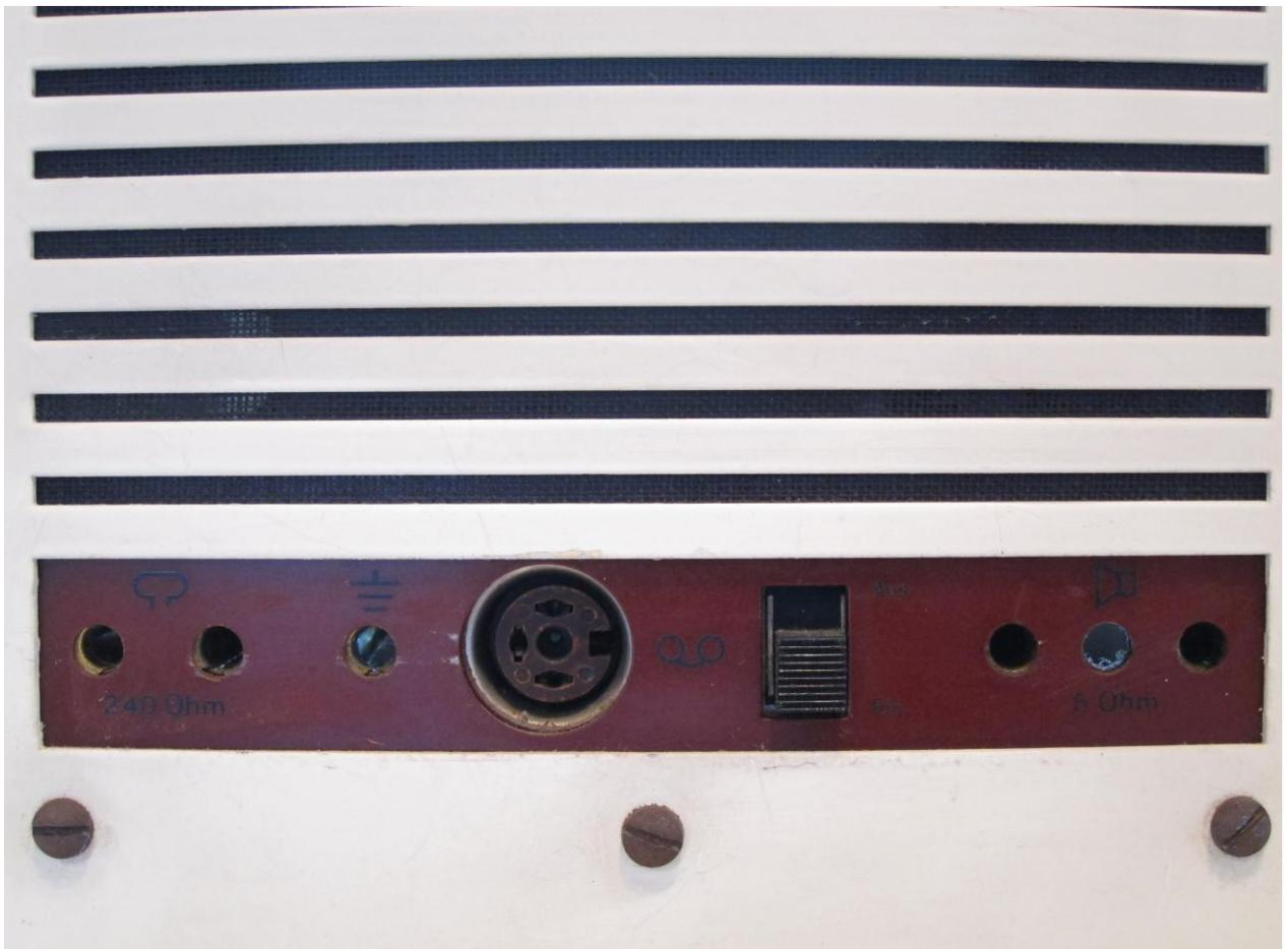
Abbildung 4: Anschlussfeld Rückseite
